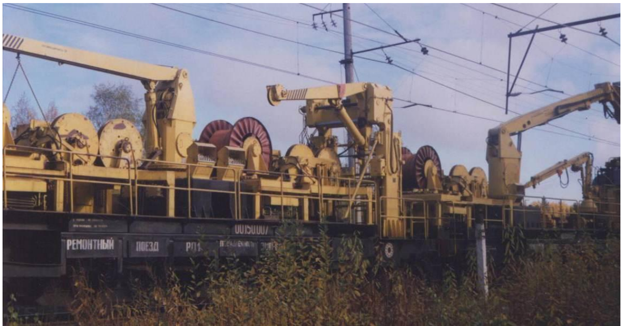
Рис. 1. Ремонтный поезд РП-1
