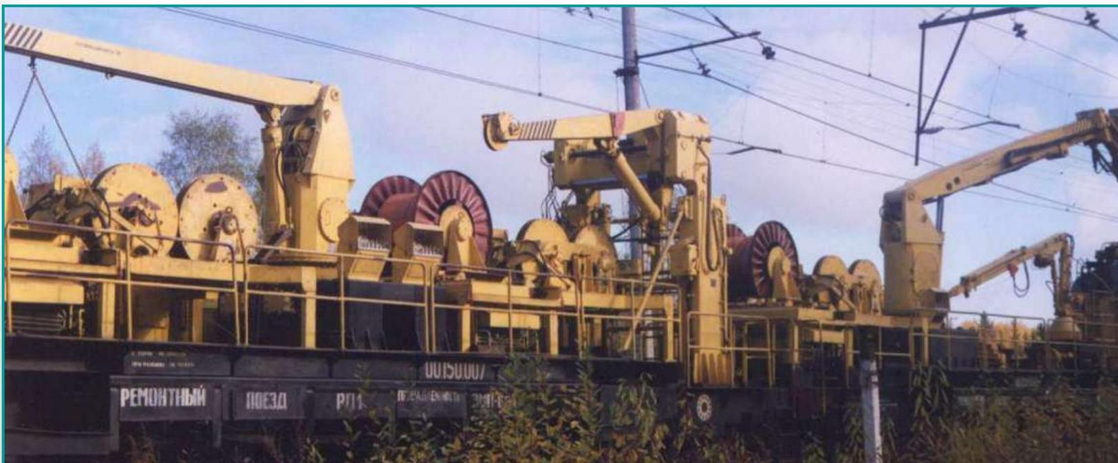
**На испытаниях на участке Яндеба – Подпорожье полная замена двух контактных проводов и несущего троса на анкерном участке выполнялась за 3 часа.**
